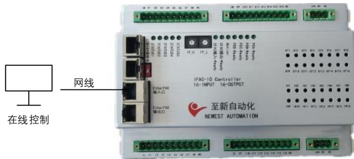
控制器可以通过 EtherFAC 总线出使用以太网电缆连接到其他设备相连, 实现多点连接。示意图如下:
